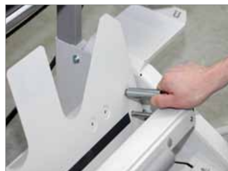
Otwory do montażu zderzaka-prowadnicy
