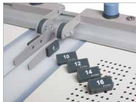
Szybko wymienne spacjiatory magnetyczne umożliwiają łatwiejszą niż dotychczas regulację odległości między kartonami okładki a paskiem grzbietowym.
